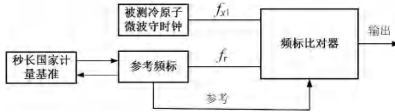
图 8 频标比对器法测试被测冷原子微波守时钟的相对频率偏差测试框图
