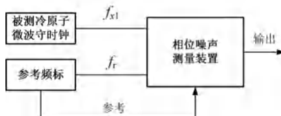
图9 被测冷原子微波守时钟的相位噪声测试框图
